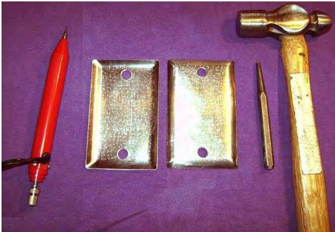
Oben sind typische Handwerkzeuge dargestellt, mit denen die Vertiefungen auf den Platten erzeugt werden. Die aktiven Plattenoberflächen, dh die 1,6 mm voneinander entfernten Oberflächen, werden eingerückt und geschliffen.
