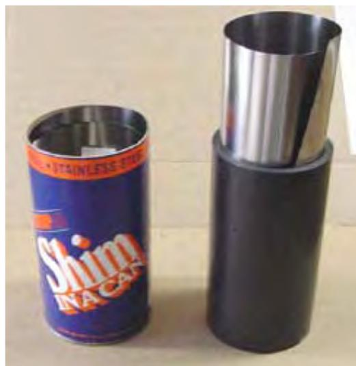
Shimstock in ABS-Schläuche schneiden und einpassen, 11 Zoll funktionieren gut, da dies eine Überlappung von 1 Zoll ergibt.
