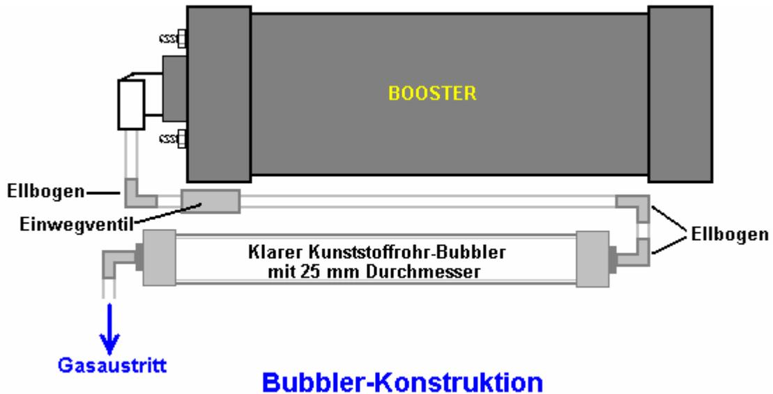
Bei den Ellbogen mit einem Durchmesser von einem halben Zoll an den Enden des Sprudelrohrs mit einem Durchmesser von einem Zoll sind die Gewinde mit Silikon beschichtet, bevor sie an ihren Platz gedrückt werden. Dies ermöglicht es beiden, im unwahrscheinlichen Fall einer Gasentzündung als Druckentlastungs-Ausstellarmatur zu fungieren. Dies ist ein zusätzliches Sicherheitsmerkmal des Designs.
