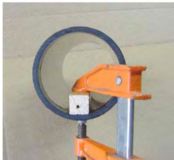
Klemmen Sie sie fest und bohren Sie nach besten Kräften zwei 0,165-Zoll-Löcher, eins auf beiden Seiten, senkrecht zueinander. Diese Löcher werden 1/4 Zoll x 20 gewindebohrt
