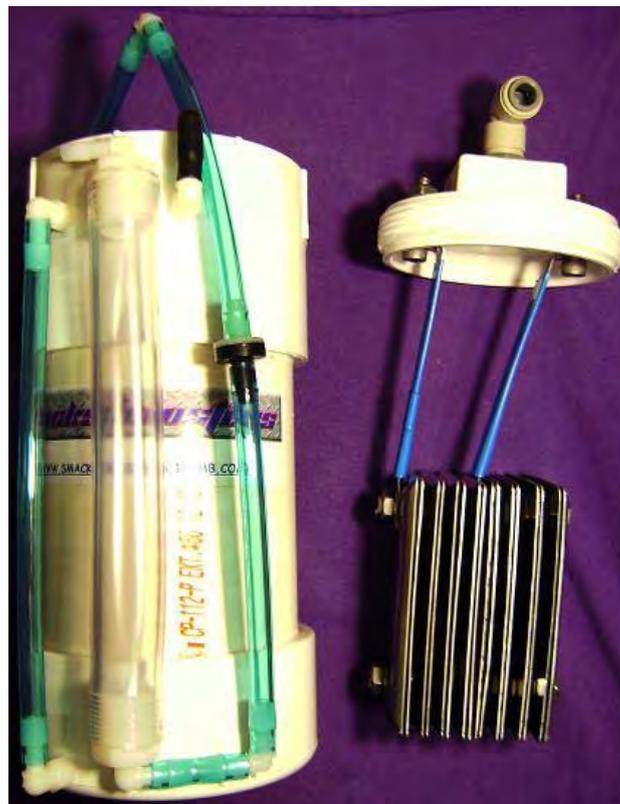
Das Bild oben zeigt deutlich, welche Wandplatten verwendet werden und wie der Sprudler mit Sekundenkleber am Gehäuse des Boosters befestigt wird. Es zeigt auch die verschiedenen Rohrverbindungen. Die Edelstahl-Schalterabdeckplatten haben eine Größe von 70 mm x 115 mm und die vorhandenen Befestigungslöcher sind mit einem Durchmesser von 8 mm (5/16 Zoll) gebohrt, um die Kunststoffschrauben aufzunehmen, die zum Halten verwendet werden die Platten zusammen, um eine
