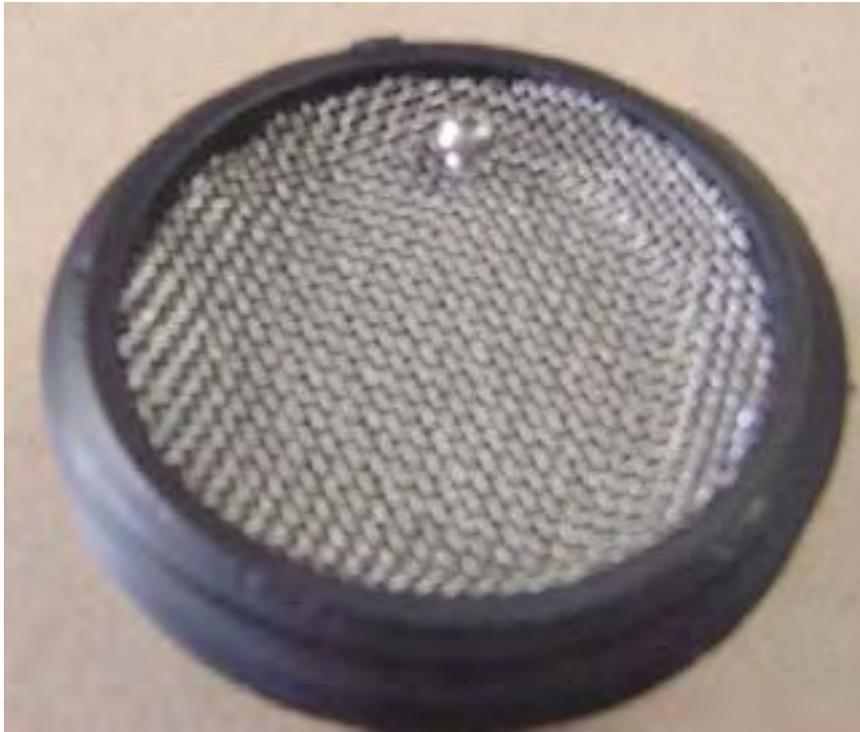
Nachdem Sie das Netz fest in die Kappe eingesetzt haben, befestigen Sie es mit einer 10/32 Zoll Edelstahlschraube auf der gegenüberliegenden Seite des 1/4 Zoll Gewindelochs für die Steckverbindung. Dies ist eine Flammensperre, machen Sie also BESTIMMT, dass das gesamte Innere dicht bedeckt ist. Beachten Sie, dass die Seiten einwickeln. Drehen Sie jede Schicht, um die Körnung des Netzes in den aufeinanderfolgenden Schichten zu kreuzen.
