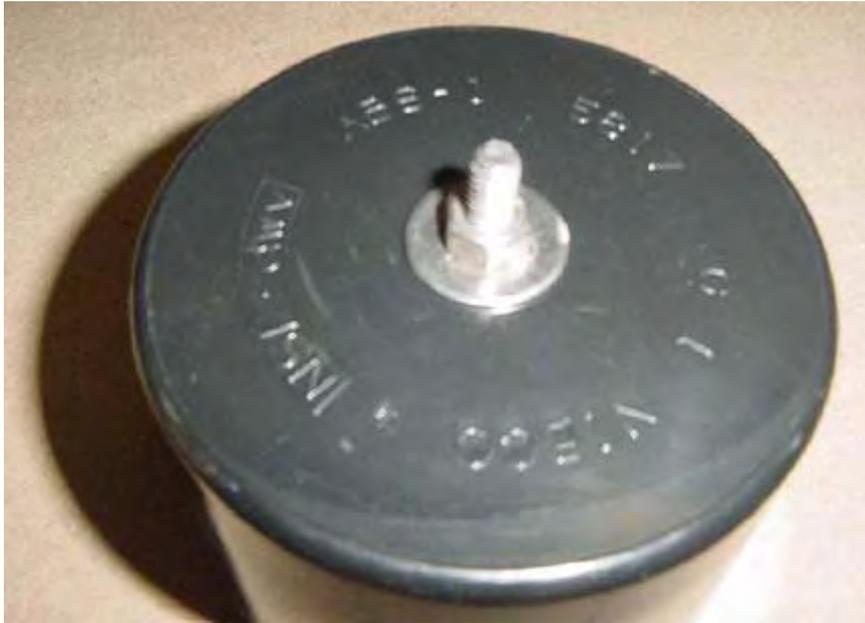
Dies ist der positive Batterieanschluss.
