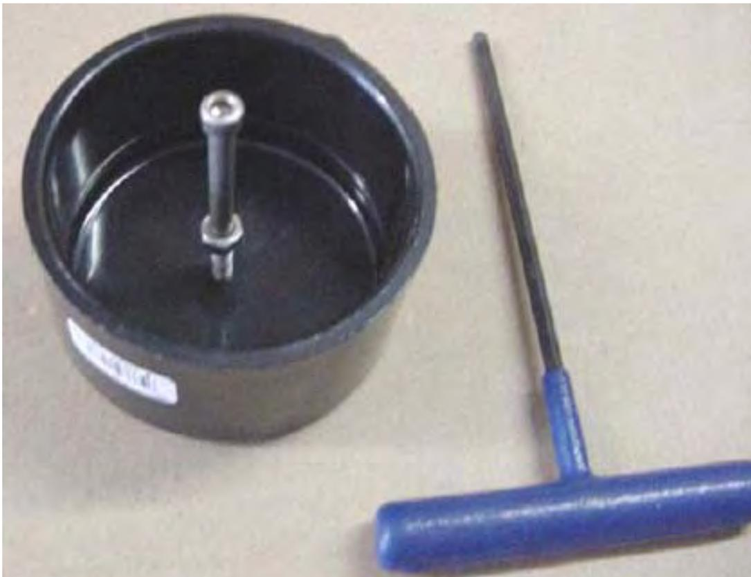
Bereiten Sie die untere Kappe vor: Bohren und tippen Sie in die Mitte auf ein Loch von 1/4 Zoll x 20. Installieren Sie die Kopfschraube mit einer Edelstahlmutter. Ziehen Sie eine Unterlegscheibe und eine Edelstahlmutter an und bringen Sie sie außen an.
