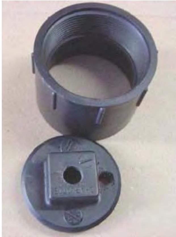
Die obere Komponente ist ein Gewintheadapter DWV 3 Zoll HXFPT. Die untere Komponente ist ein 3-Zoll-ABS-Stopfen. Reinigen Sie die Gewindekappe. Bereiten Sie die obere Kappe und den Stopfen vor: Bohren Sie in die Mitte der Gewindekappe (dies ist der Hauptfüllstopfen) ein NPT mit 3/8 Zoll Durchmesser und klopfen Sie darauf. Bohren und tippen Sie auf einen 1/4 Zoll NPT an der Seite (um die mit Widerhaken versehene Verschraubung zu nehmen).
