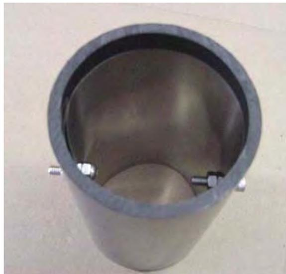
Beachten Sie, dass der Distanzhalter mit dem Boden des Rohrs bündig ist. Endmontage der Elektroden. Beachten Sie, dass die Kopfschrauben jeweils Edelstahlmuttern im Inneren des Laufs haben, um auf dem Distanzstück zu sitzen. Die Schraube auf der linken Seite wird als negativer Batterieanschluss für die Zelle verwendet, während die Schraube auf der rechten Seite lediglich den Ausgleichscheibenstock aufnimmt.
