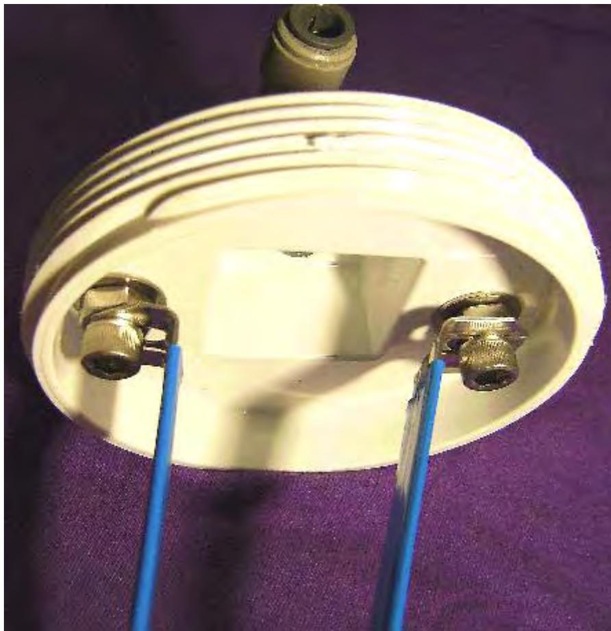
Um sicherzustellen, dass die Edelstahlbänder fest mit der elektrischen Verkabelung verbunden sind, befinden sich die Kappenschrauben beide auf der robusten, horizontalen Oberfläche der Kappe und sind innen und außen sicher festgeklemmt. Eine Gummiunterlegscheibe oder Gummidichtung wird verwendet, um die Abdichtung an der Außenseite der Kappe zu verbessern. Falls verfügbar, kann eine Stahlscheibe mit integrierter Gummibeschichtung verwendet werden.
